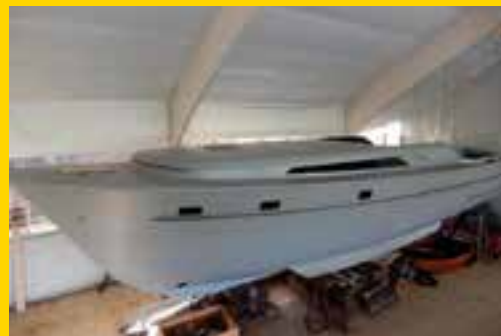
Vink Super Casco 13,20m x 4,00m. Dit casco is geheel naar eigen inzicht af te bouwen. Een boeg- en hekschroeftunnel zijn ingelast.
