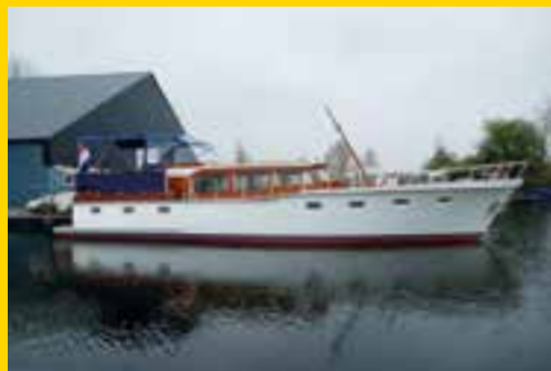
Super Van Craft 15,00 (1968). Voorzien van 2 DAF 575 motoren à 105pk en boegschroef. Het schip heeft altijd binnen gelegen.
